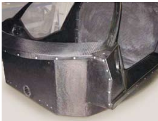
CFK Prepreg-Struktur (Karosserieteil), hergestellt mit ebacryl Werkzeugen
