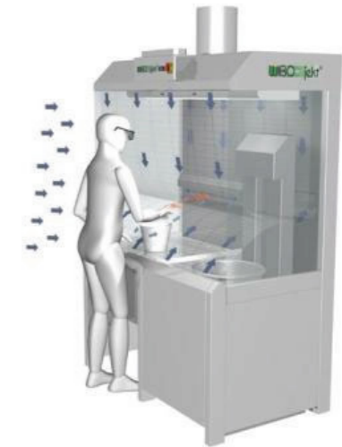
Schematische Darstellung Lüftungsprinzip WIBOjekt® für den Personen- und Umgebungsschutz
