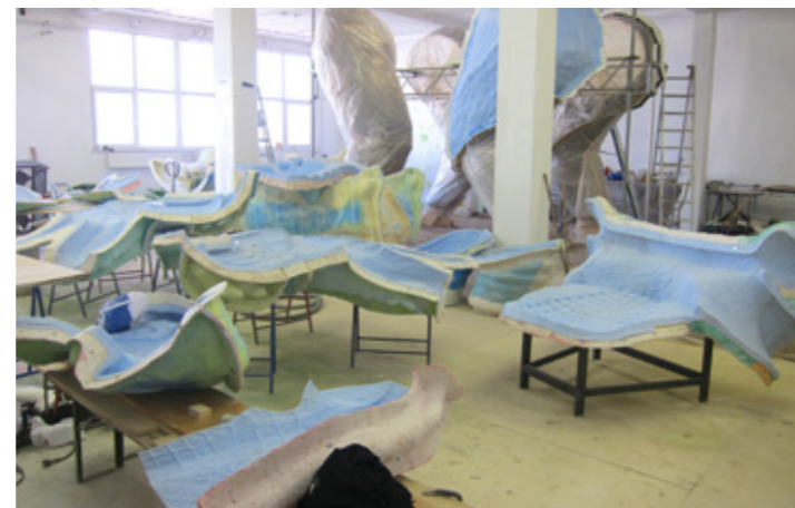
Produktionsformen aus ebacryl für die ca. 1.000 kg schwere Drachenhaut, die aus dem Epoxidharz AH 140 gefertigt wurde
