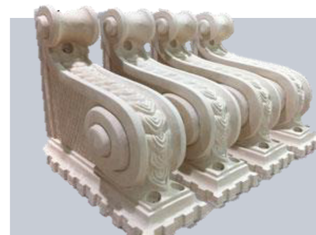
Kleinserienfertigung in ebacryl Produktionsform
