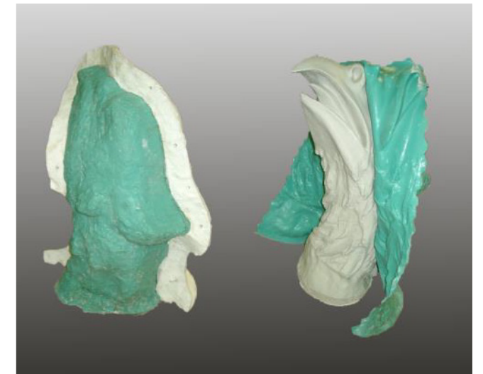
Gipsreproduktion in ebacryl Stützschaale und Silikonhaut hergestellt
