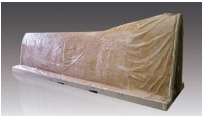
Rohling für Galvanobadmodell Flugzeugteil aus ebablock® M 007 Bildnachweis: Konrad Schäfer GmbH
