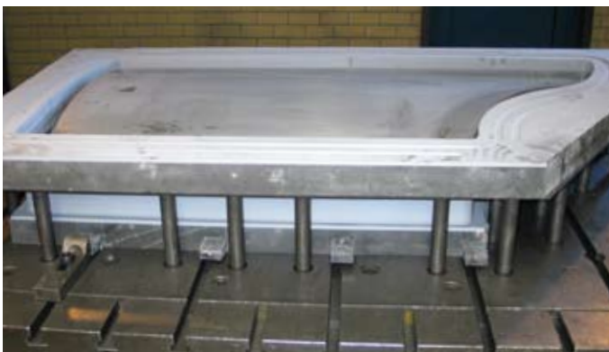
Umformwerkzeug aus ebablock ® W (Türäußenhaut einer Luxuslimousine)
