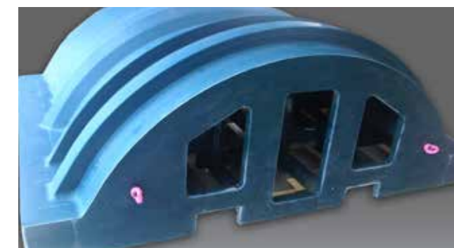
Urmodell aus ebablock® P 185 für ein Prepregwerkzeug. Größe: 3760 x 2990 x 1640 mm. Volumen: 3000 ltr.
