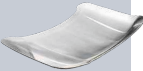
Nickelschalenwerkzeug gefertigt im Galvanobad auf ebablock® P 185
