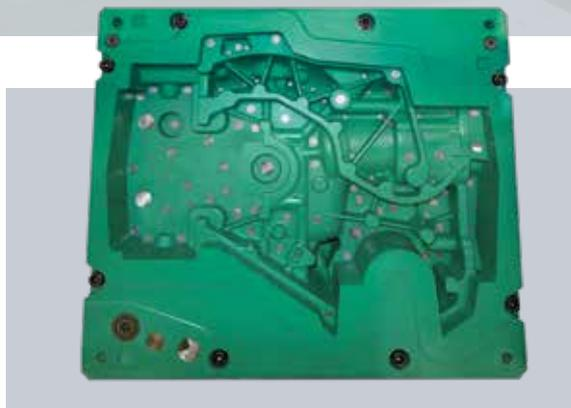
*Kernkasten aus ebaboard PW 920 für ein Getriebegehäuse*
